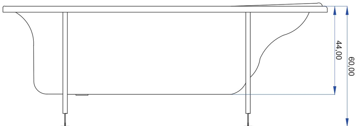
**Nota:** Recomendamos colocar a 20cm, como mínimo, del desagüe la conexión a cloaca del piso.
