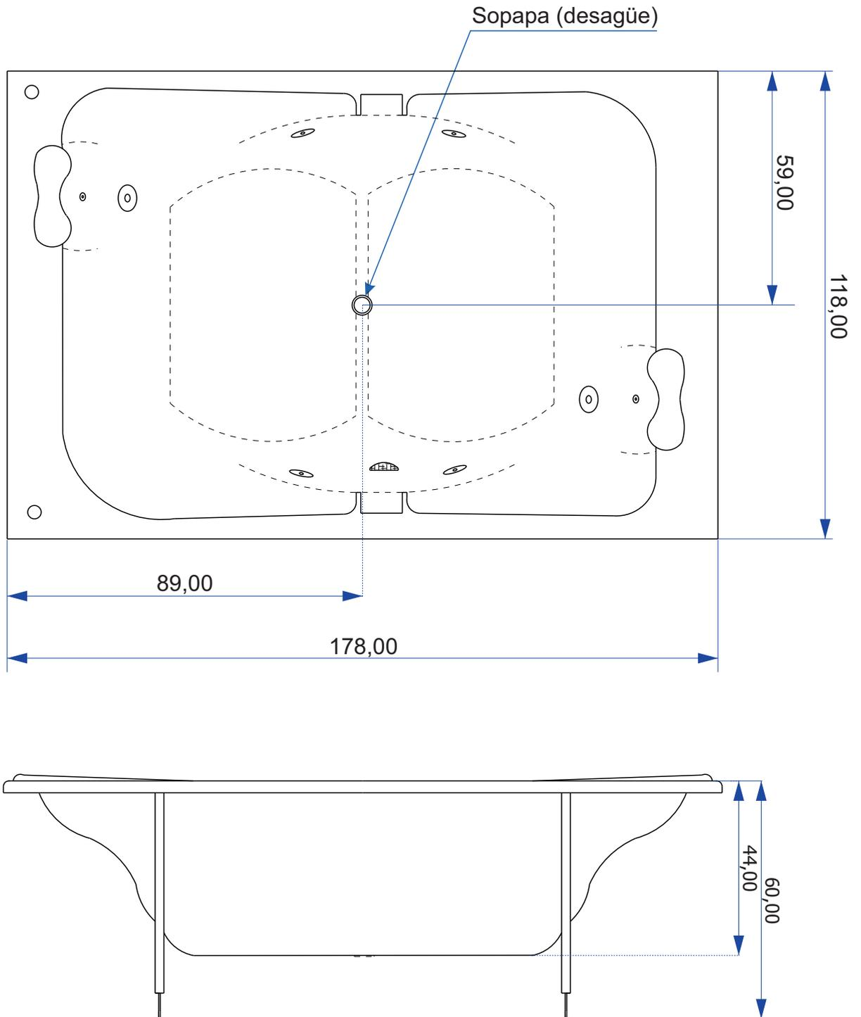
**Nota:** Recomendamos colocar a 20cm, como mínimo, del desagüe la conexión a cloaca del piso.
