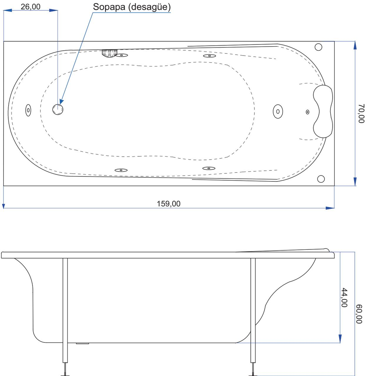
**Nota:** Recomendamos colocar a 20cm, como mínimo, del desagüe la conexión a cloaca del piso.
