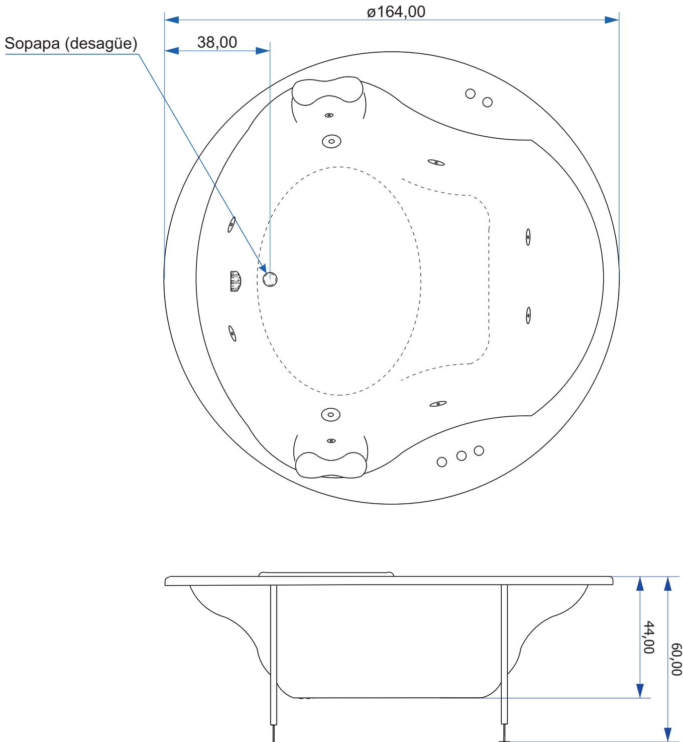
**Nota:** Recomendamos colocar a 20cm, como mínimo, del desagüe la conexión a cloaca del piso.
