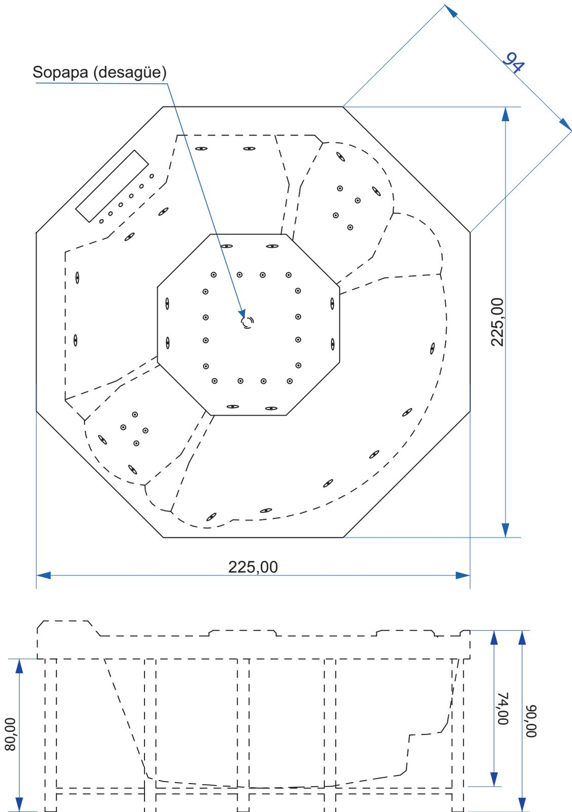
**Nota:** Recomendamos colocar a 20cm, como mínimo, del desagüe la conexión a cloaca del piso.
