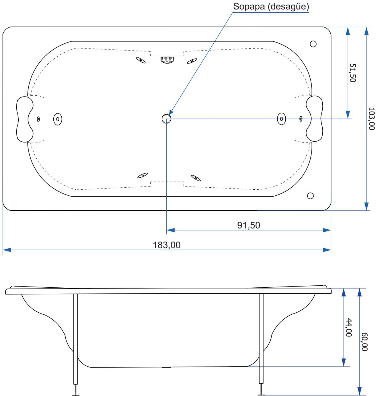
**Nota:** Recomendamos colocar a 20cm, como mínimo, del desagüe la conexión a cloaca del piso.
