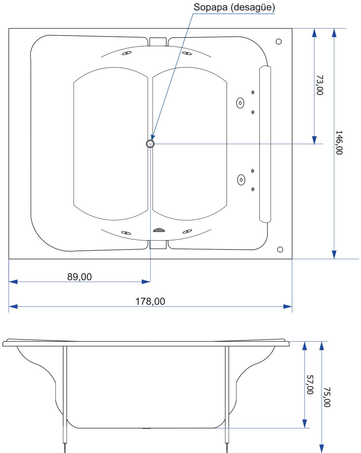
**Nota:** Recomendamos colocar a 20cm, como mínimo, del desagüe la conexión a cloaca del piso.
